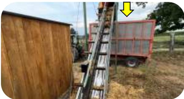
C) Déverser le fumier dans une benne ou directement dans la fumière (Opération automatisée)
